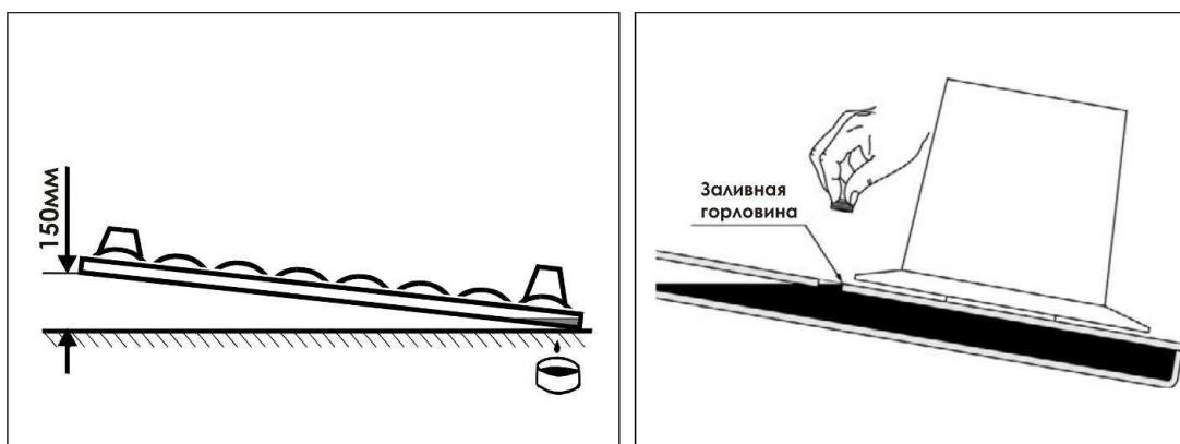
Рисунок 7.1 - Проверка уровня масла в режущем аппарате
