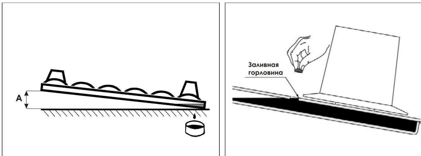
Рисунок 8.3 - Проверка уровня масла в режущем аппарате
