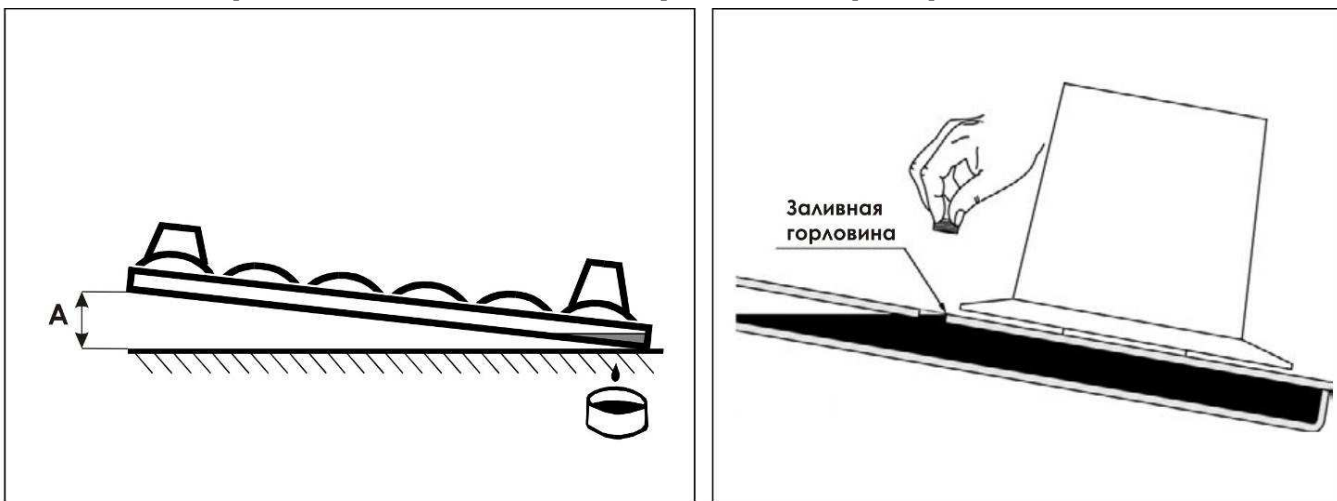
Рисунок 8.3 – Проверка уровня масла в режущем аппарате
