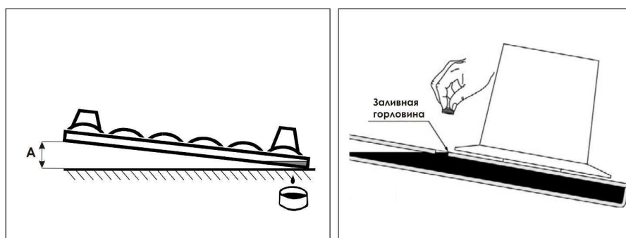
Рисунок 8.3 - Проверка уровня масла в режущем аппарате
