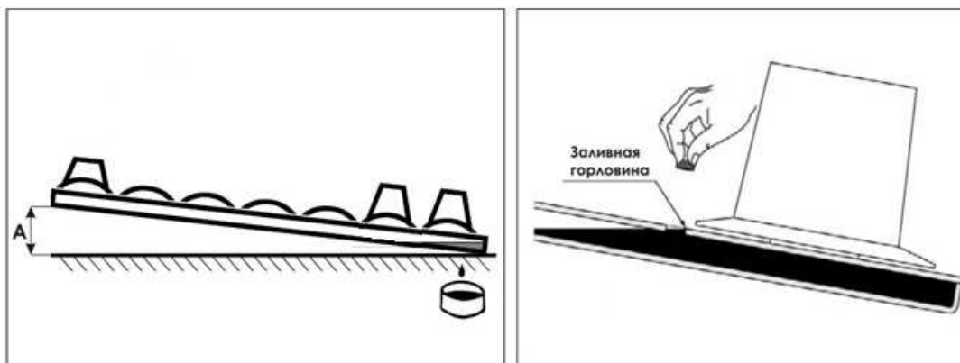
Рисунок 8.3 - Проверка уровня масла в режущем аппарате
