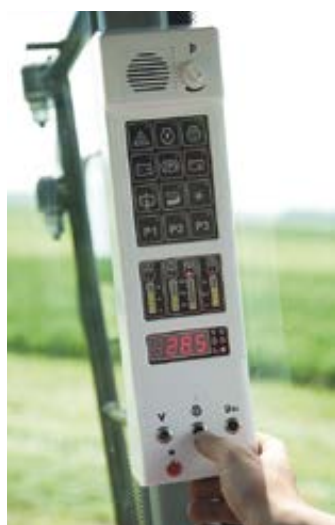
Информационная панель с автоматической системой контроля технологического процесса.
