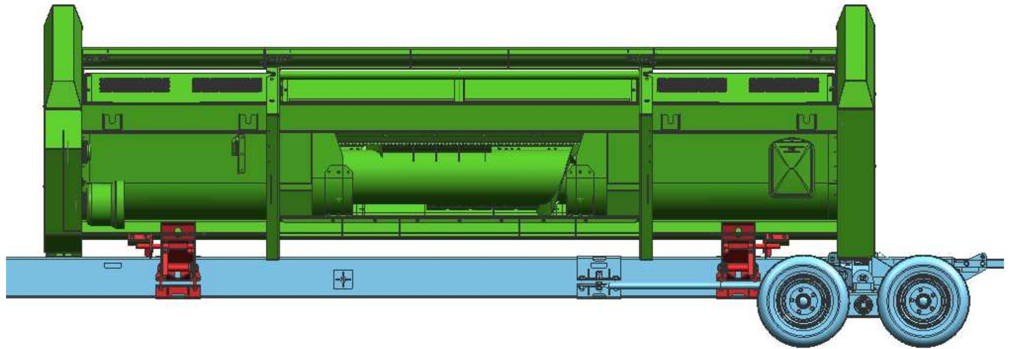
Рисунок Д.5 - Приспособление модульное для перемещения адаптеров ПМА-4000 «Pro Cart 4000» с установленной жаткой RSM SS-490 (SS-560) и комплектом для транспортировки SS-490.23.00.000 (SS-490.23.00.000-01)
