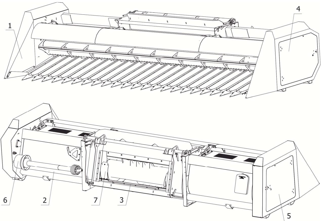
1 – Жатвенная часть; 2 – Карданная передача; 3 – Рамка переходная; 4, 5 – Защитные щитки;
