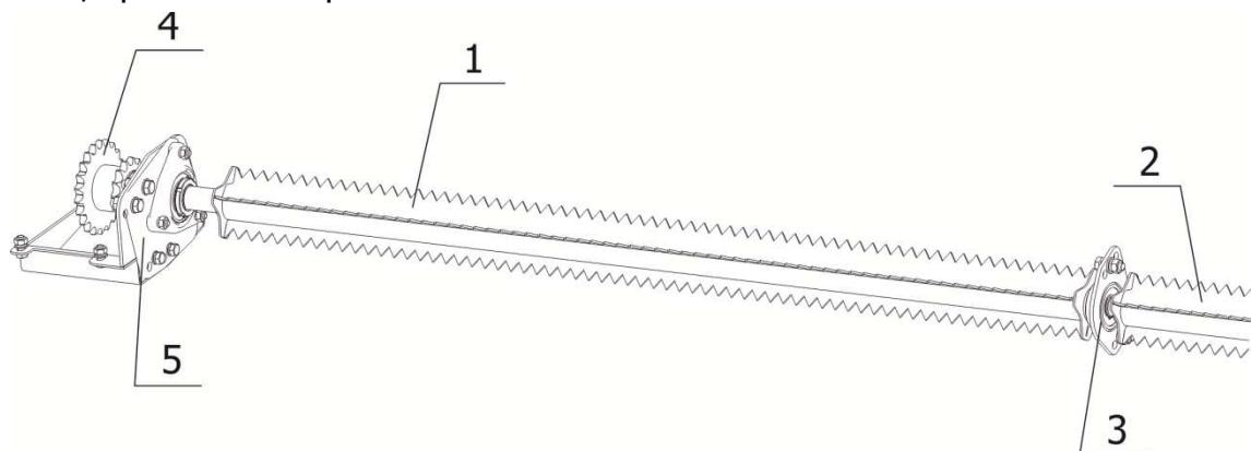
1 – Ведущий вал; 2 – Ведомый вал; 3 – Корпус подшипников; 4 – Блок звёздочек;
