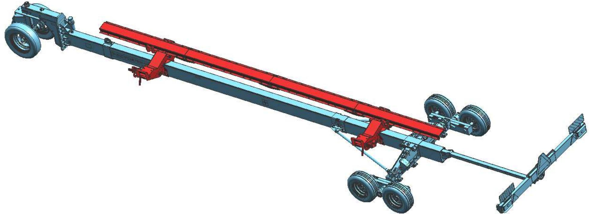
Рисунок Д.10 - Приспособление модульное для перемещения адаптеров ПМА-4000 «Pro Cart 4000» для жатки RSM SS-650 с комплектом для транспортировки SS-780.23.00.000
