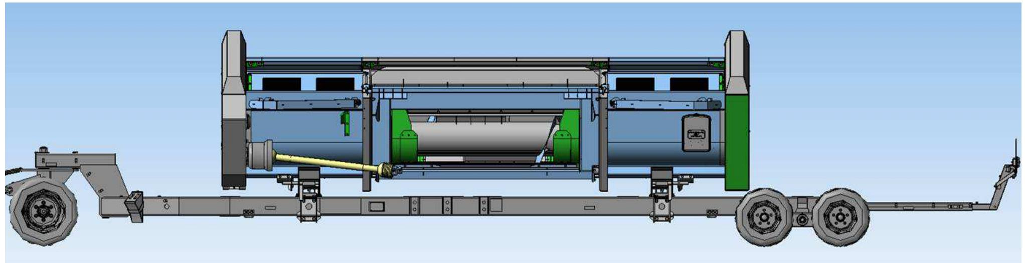
Рисунок Д.1 – Приспособление для перемещения адаптеров ППА-4000 “Uni Cart 4000” с установленной жаткой RSM SS-490
