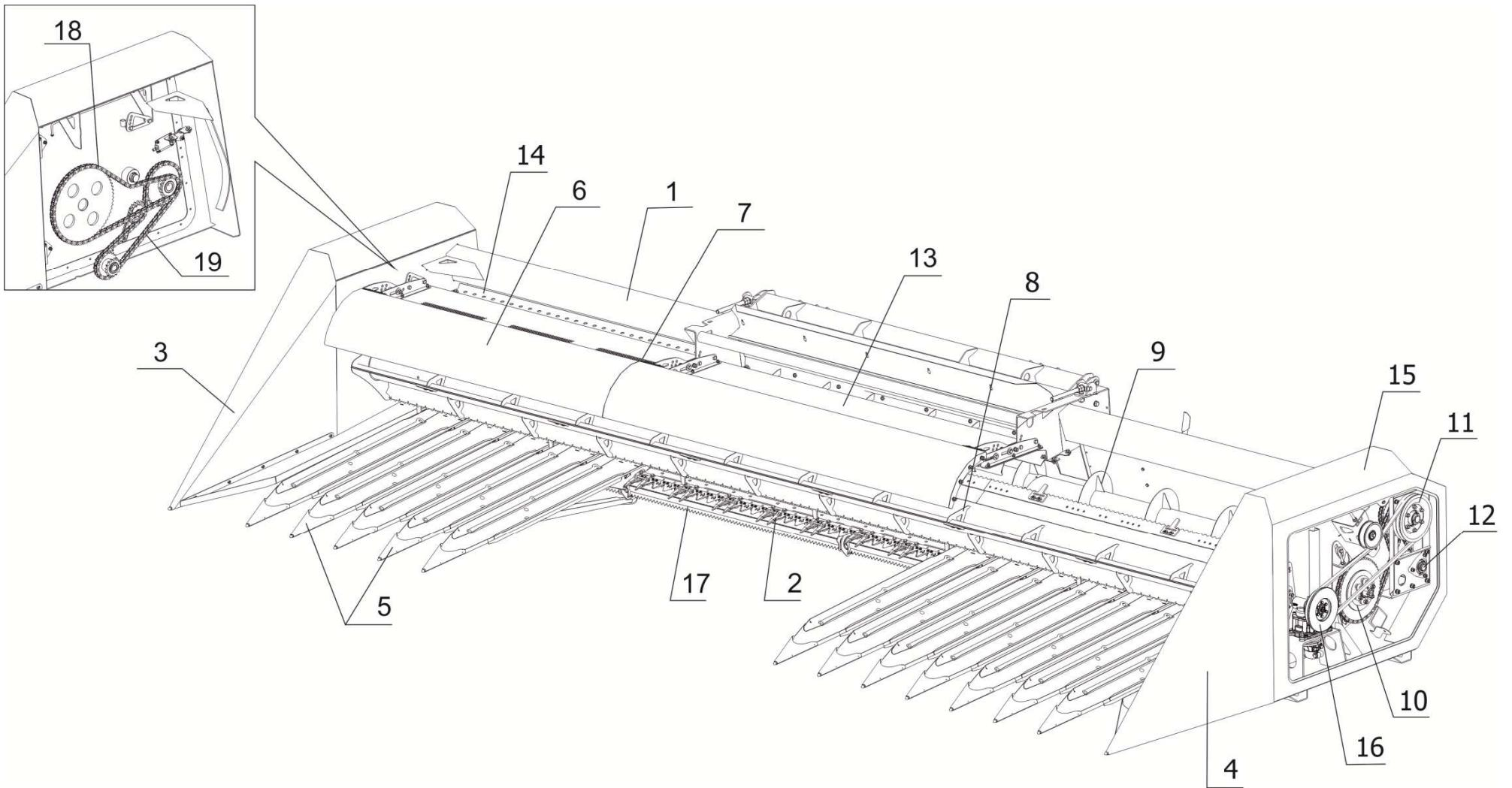
1 – Рама; 2 – Режущий аппарат; 3, 4 – Боковой делитель; 5 – Делитель; 6 – Направляющий щиток; 7 – Улавливающий щиток; 8 – Мотовило; 9 – Шнек;
