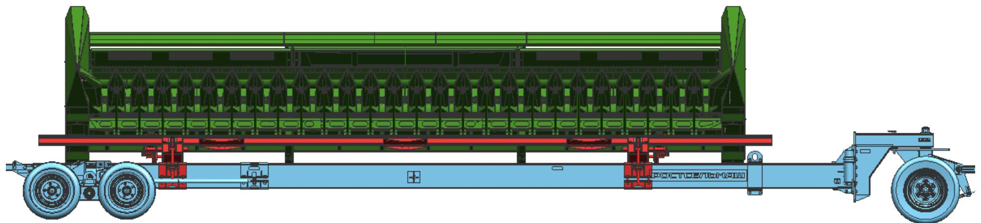
Рисунок Д.9 - Приспособление модульное для перемещения адаптеров ПМА-4000 «Pro Cart 4000» с установленной жаткой RSM SS-650 и комплектом для транспортировки SS-780.23.00.000
