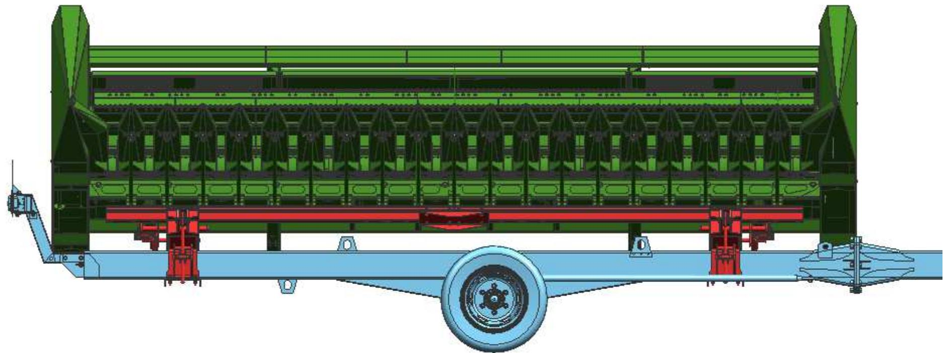
Рисунок Д.7 - Приспособление для перемещения адаптеров ППА-700 «Uni Cart 3000» с установленной жаткой RSM SS-490 (SS-560) и комплектом для транспортировки SS-490.23.00.000-02 (SS-490.23.00.000-03)
