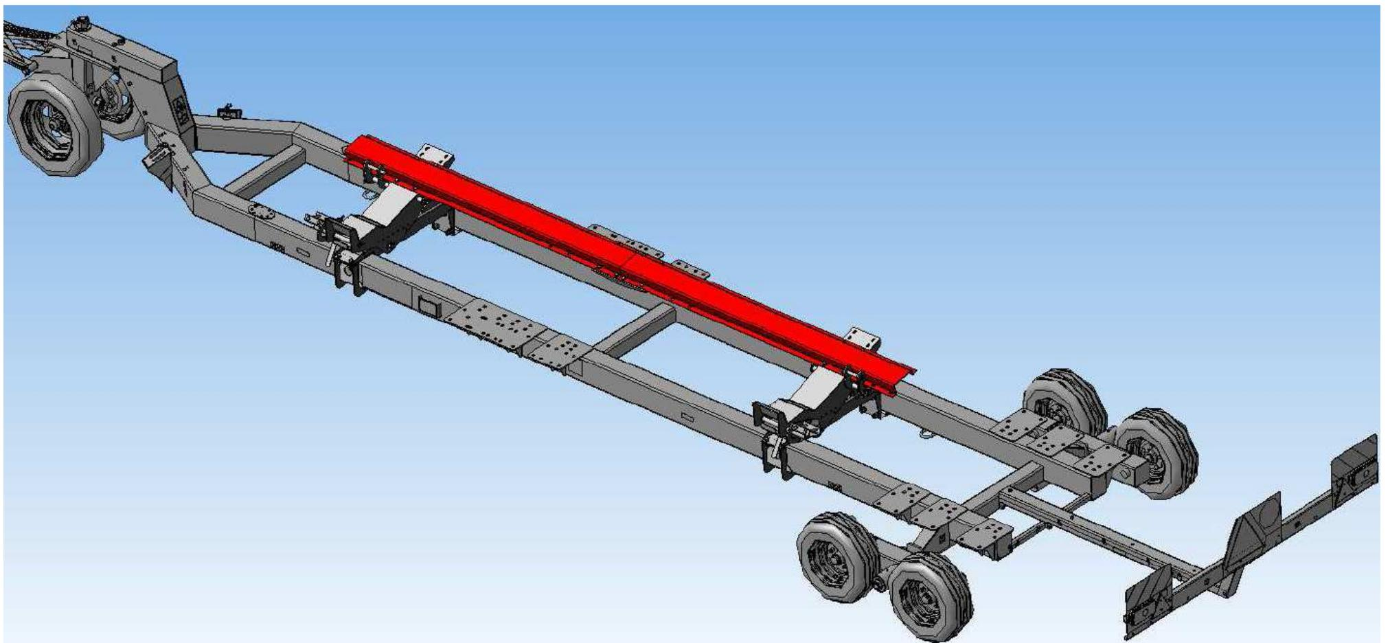
Рисунок Д.2 – Приспособление для перемещения адаптеров ППА-4000 “Uni Cart 4000” для RSM SS-490
