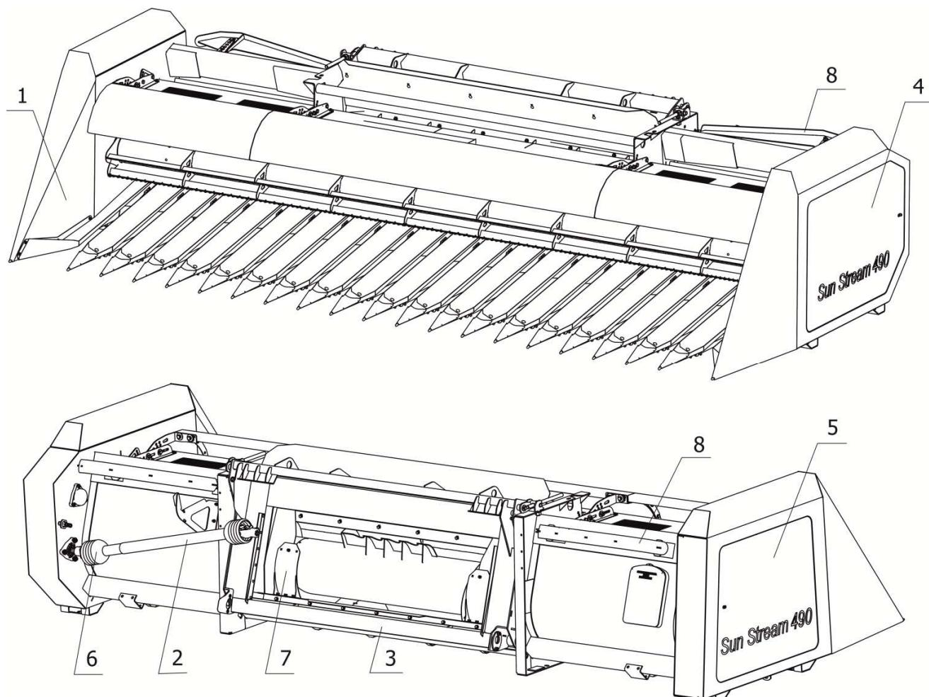
1 – Жатвенная часть; 2 – Карданская передача; 3 – Рамка переходная; 4, 5 – Защитные щитки;
