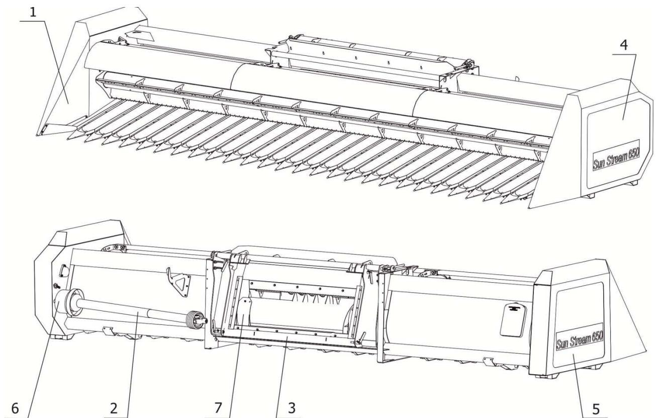
1 – Жатвенная часть; 2 – Карданная передача; 3 – Рамка переходная; 4, 5 – Защитные щитки;
