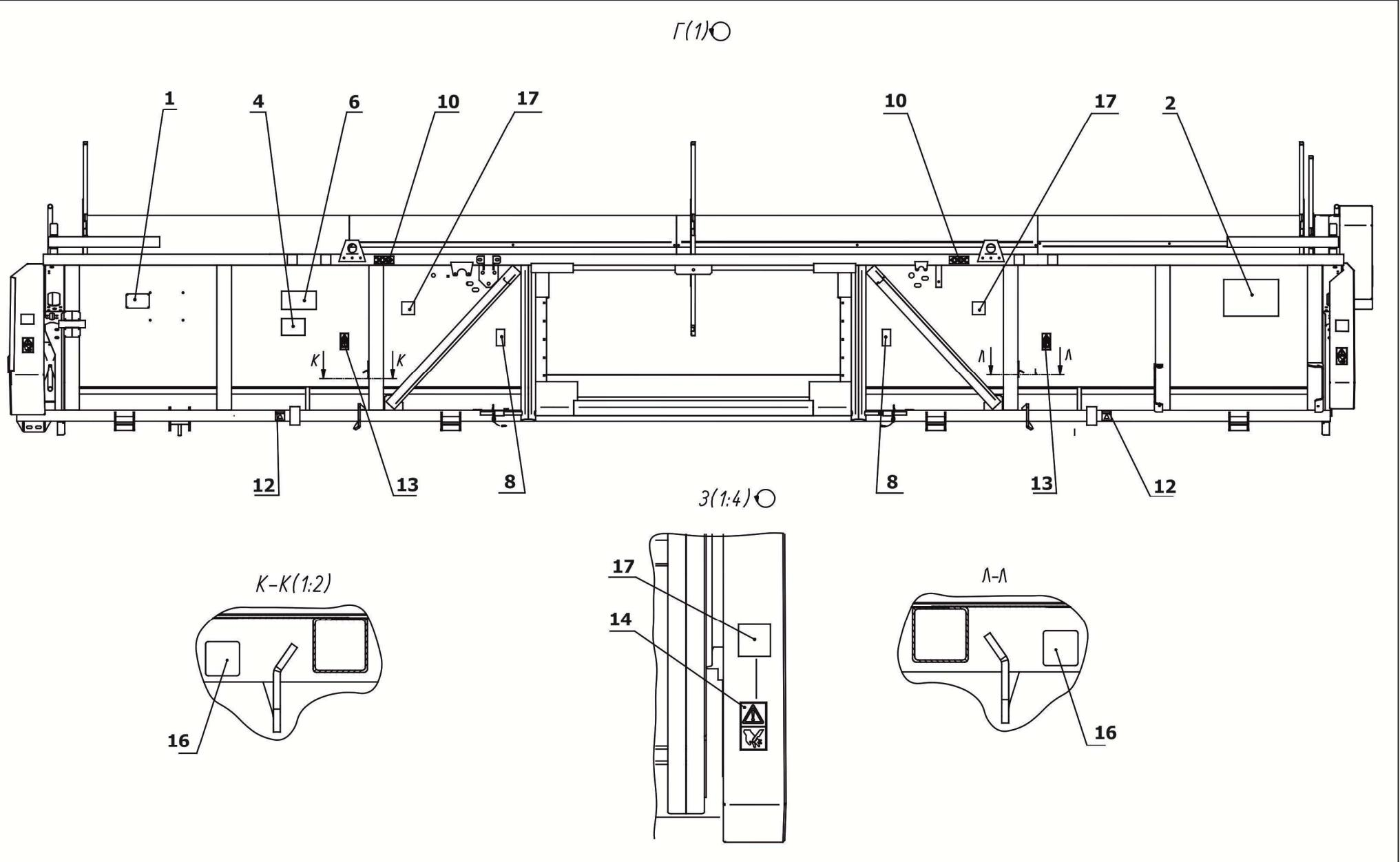
Рисунок 4.2 – Схема расположения табличек и аппликаций на жатке
