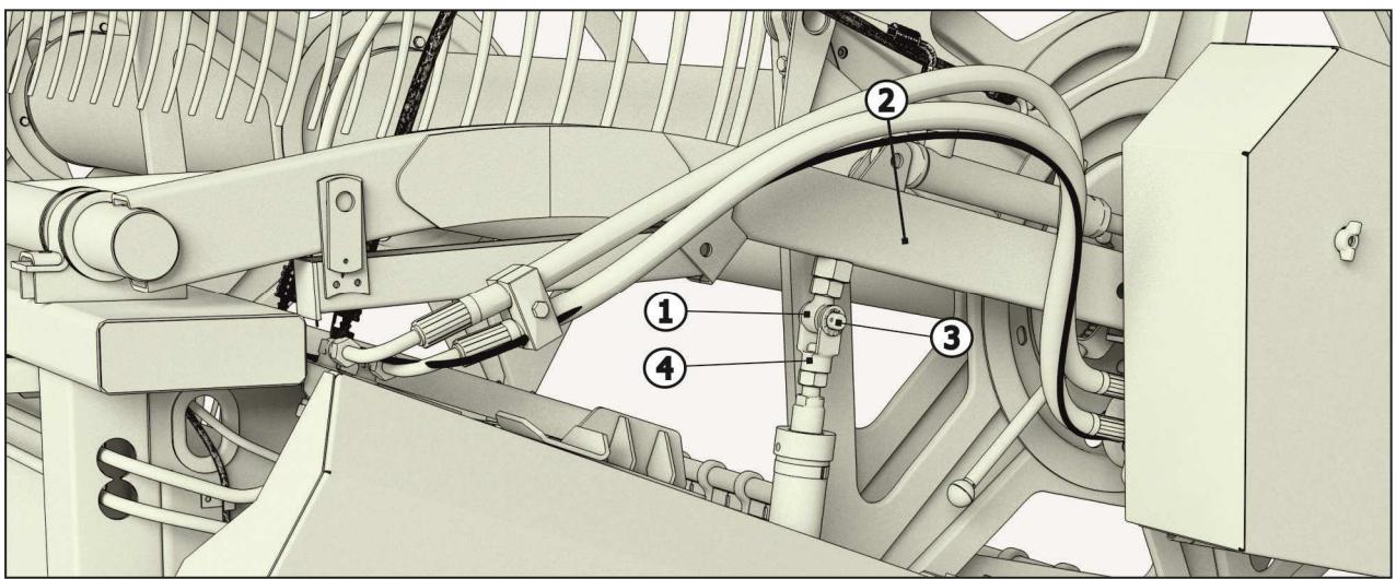
1 – винт; 2 – поддержка; 3 – ось; 4 - вилка гидроцилиндра
