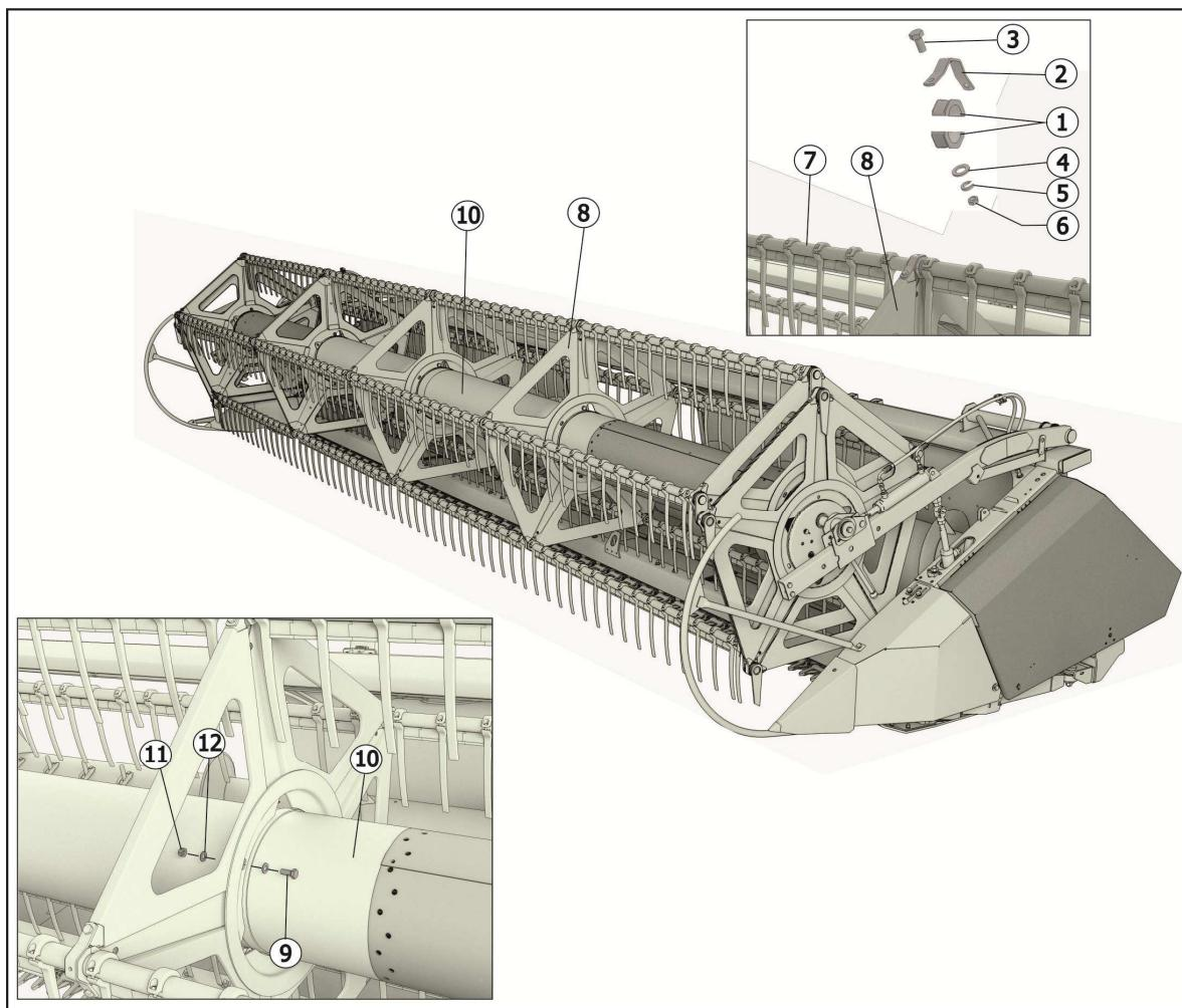
1 - полуподшипник; 2 – скоба; 3, 9 - болт; 4,5, 12 - шайба; 6, 11 - гайка; 7 - граблина; 8 - крестовина;
