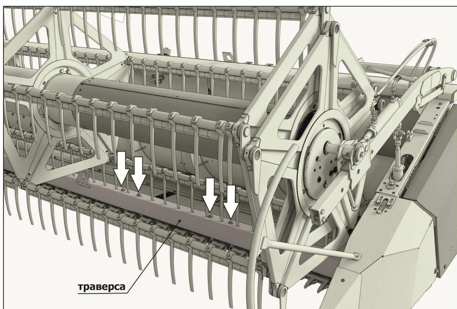
Рисунок – 8.1 Установка траверсы на жатку
