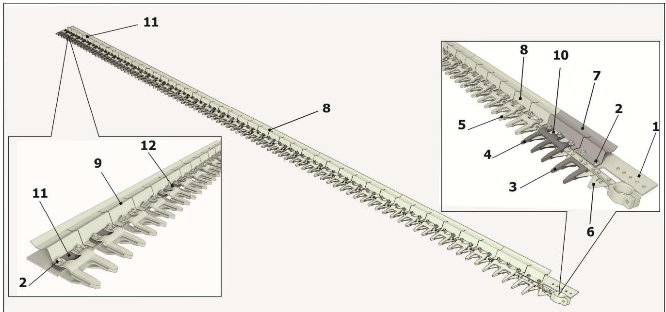
1 - брус; 2 - болтокрепеж; 3, 4, 5 – палец; 6 –нож; 7, 8, 9 – камнеотбойник;
