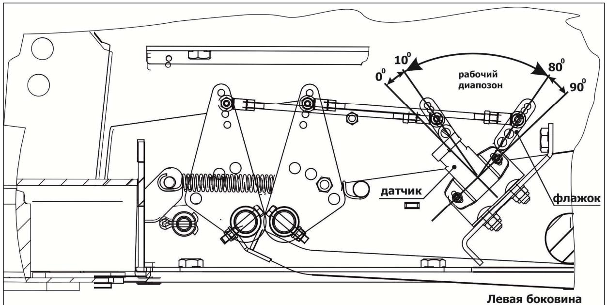
Рисунок 6.15 – Рабочий диапазон датчика положения
