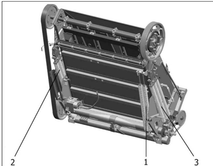
1 - блок пружин нижний; 2,3 - блоки пружин боковые
