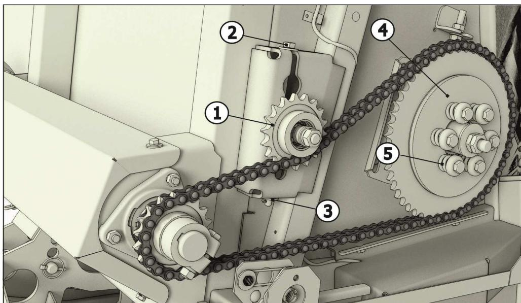
1 - звездочка натяжная; 2 – болт; 3-шайба; 4 – предохранительная муфта шнека; 5 - пружина
