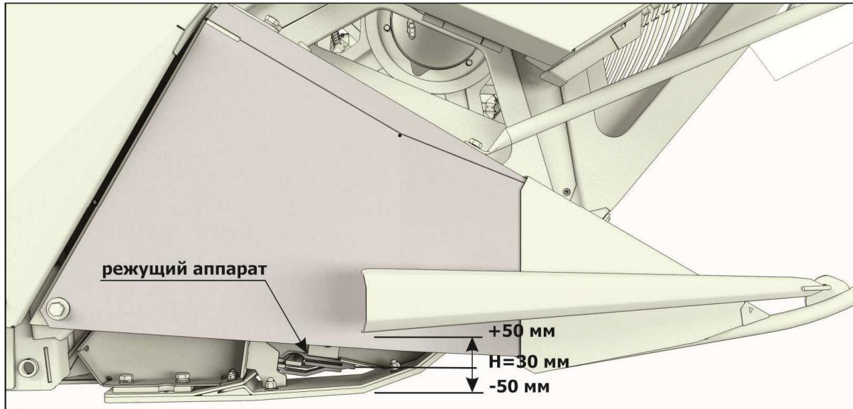
Рисунок 6.10 - Положение режущего аппарата для уборки сои
