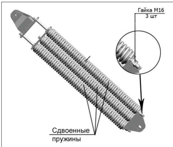
Рисунок 5.6 - Блок пружин
