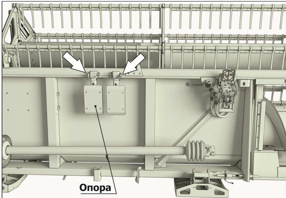
Рисунок 5.9 - Установка опор
