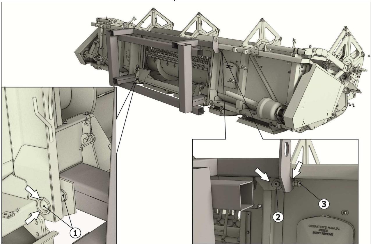
1 – фиксатор погрузочной рамки; 2 – болтокрепеж; 3 - болт
