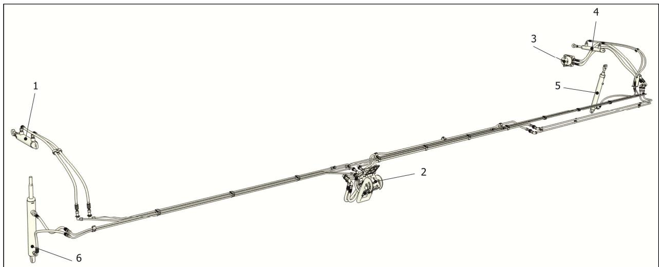
1, 4 - гидроцилиндры горизонтального выноса мотовила; 2 - единый гидроразъем;
