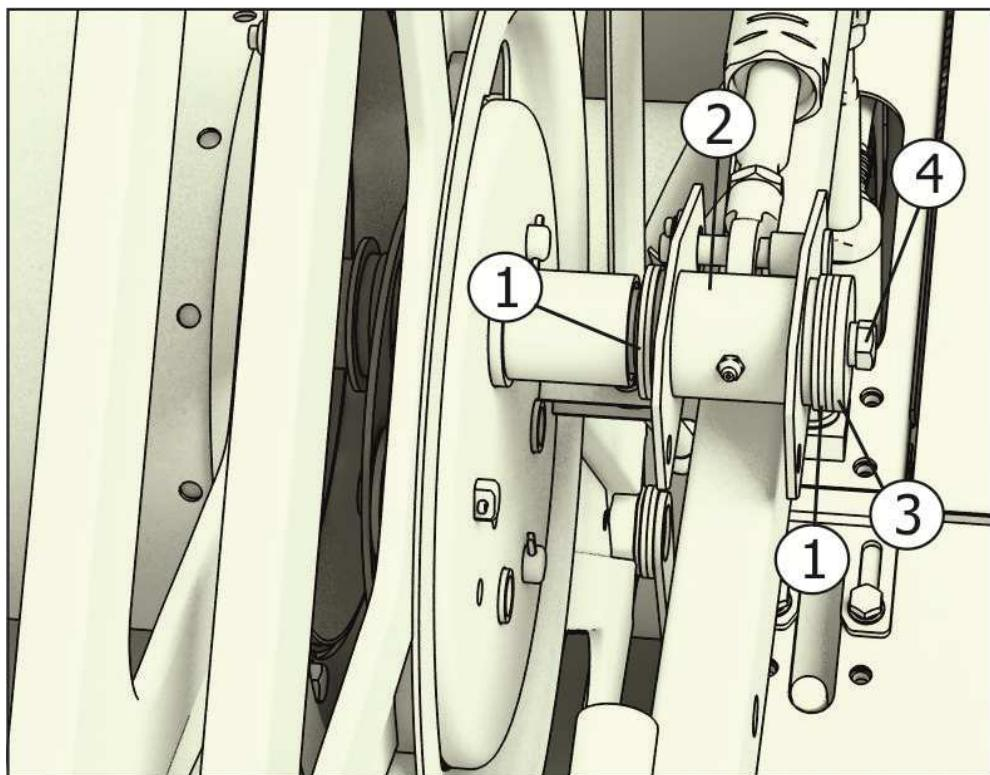
1 - шайба регулировочная; 2 – подшипник; 3 - шайба специальная; 4 - болт торцевой
