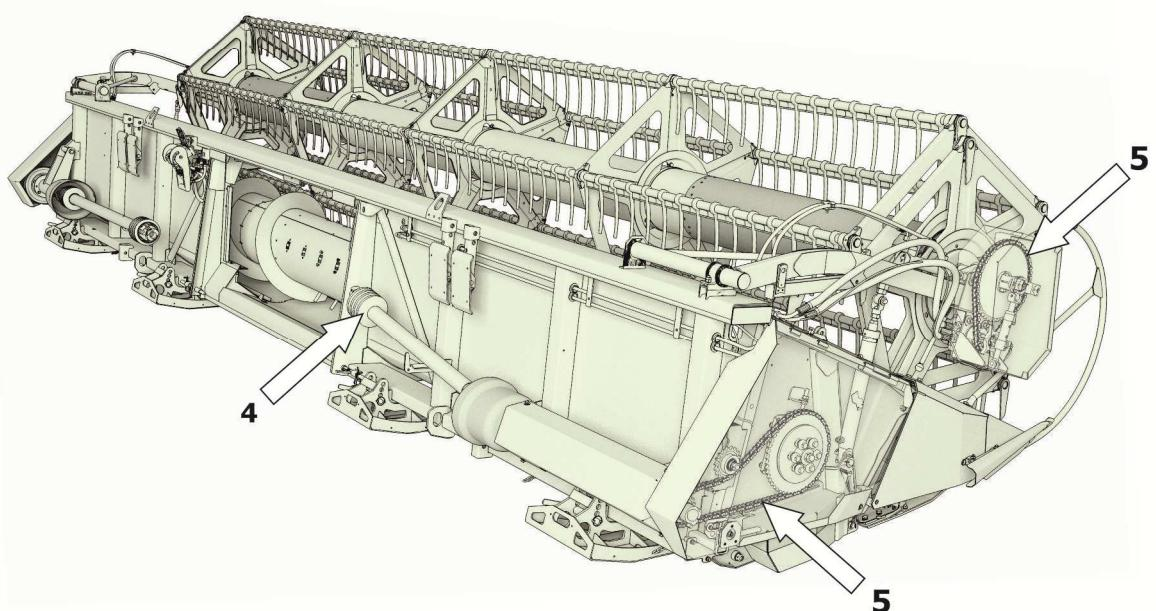
Рисунок 7.1 - Точки смазки жатки
