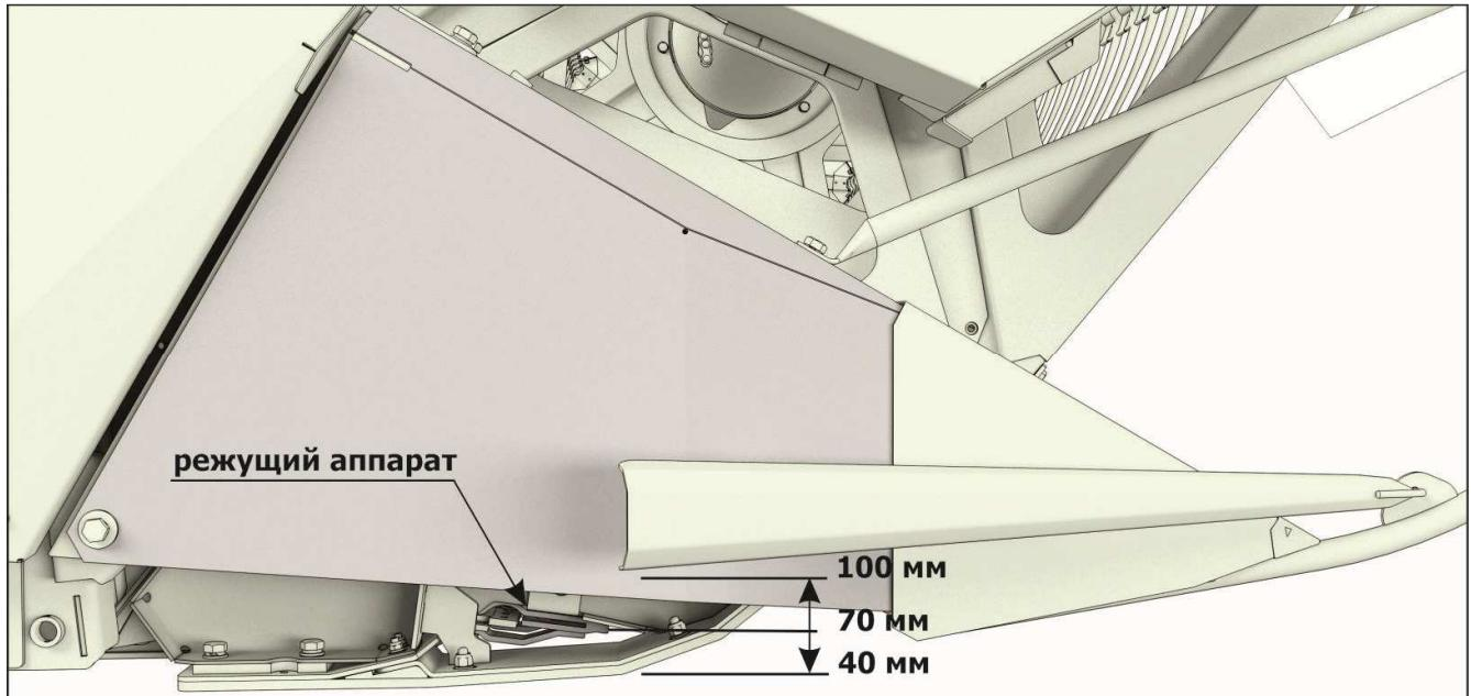
Рисунок 6.13 - Положение режущего аппарата при уборке зерновых
