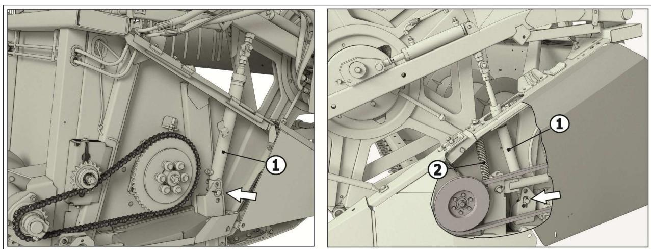
1 - гидроцилиндр; 2 – передняя вертикальная пружина
