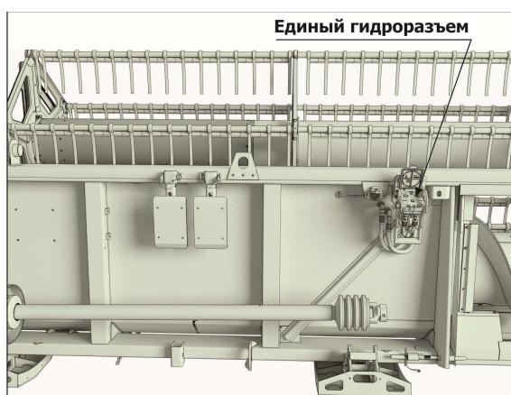
Рисунок 2.10 - Единый гидроразъем на жатке RSM FS-703
