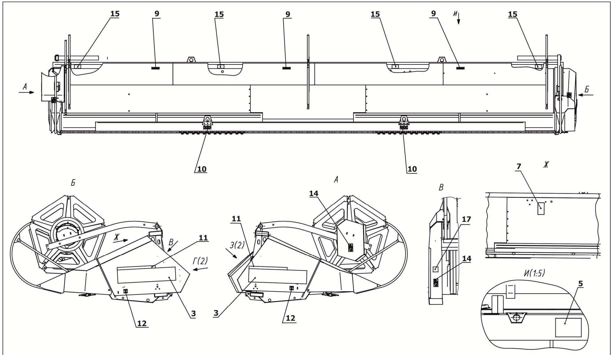
Рисунок 4.1 – Схема расположения табличек и аппликаций на жатке
