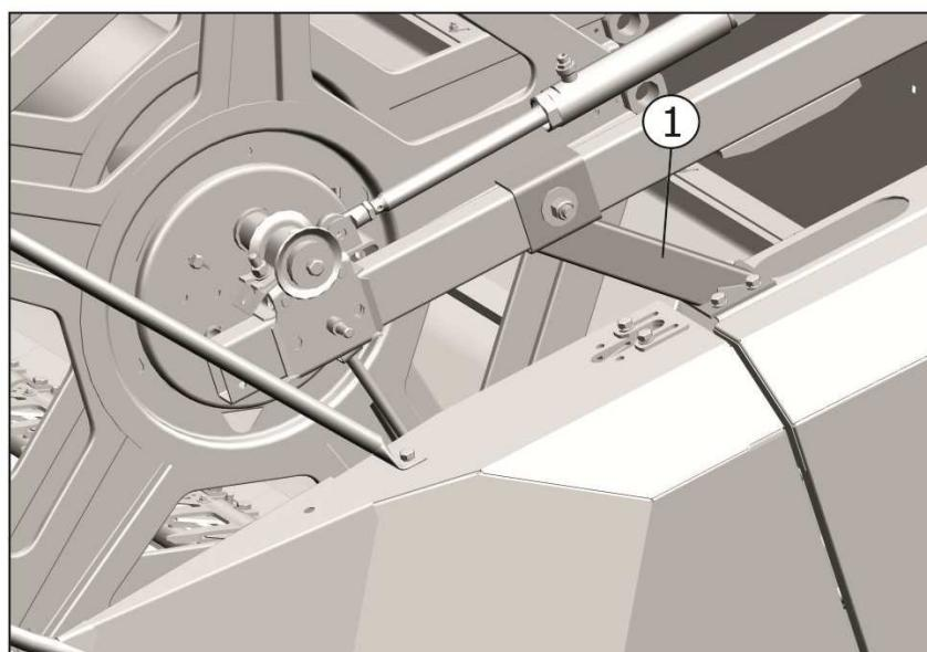
1 - транспортные фиксаторы мотовила
