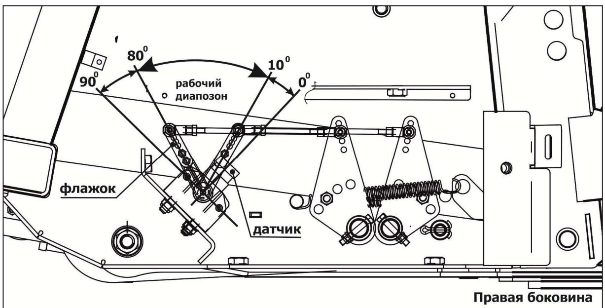
Рисунок 6.16 – Рабочий диапазон датчика положения
